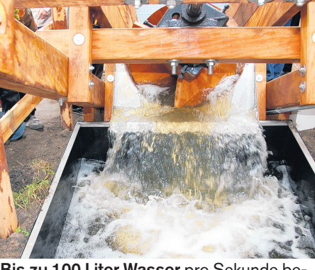
Bis zu 100 Liter Wasser pro Sekunde befördert die 5,20 Meter lange archimedische Schnecke in den höher gelegenen Vorfluter.
